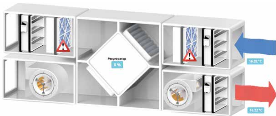
Рис. 1. Трехмерное изображение вентиляции здания горной станции гондольного подъемника. Поступающий наружный воздух (синяя стрелка) нагревается отработанным теплом из машинного отделения гондольного подъемника (рекуператор), а затем используется (красная стрелка) для вентиляции snack-бара. Области, отмеченные синим цветом, являются фильтрами; предупреждающие знаки указывают на ожидаемую замену фильтров. Круглые барабаны ниже показывают вентиляторы
