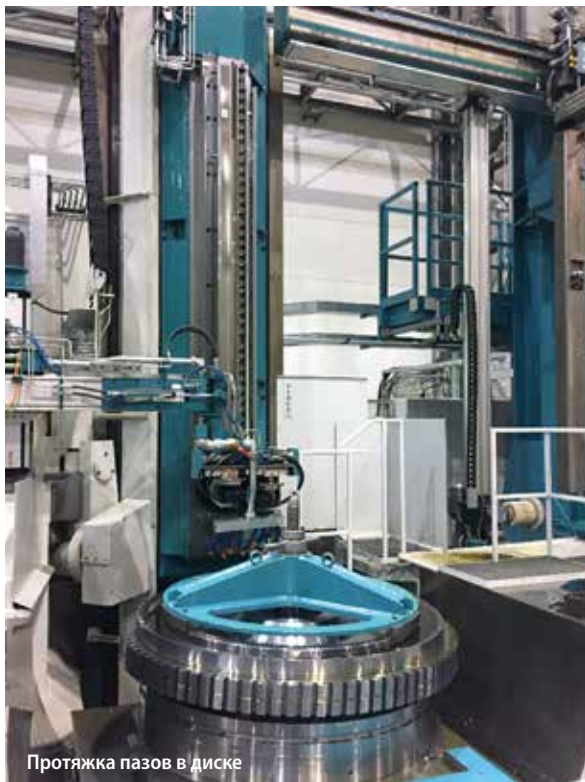
Механическая обработка среднего корпуса турбины
