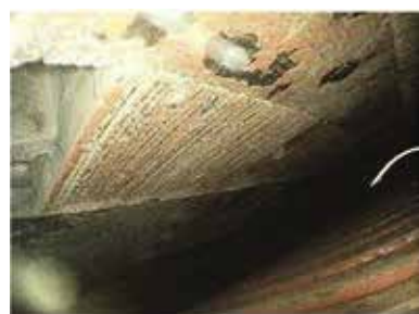
Рис. 3. Шихтованный сердечник статора электродвигателя мощностью 10000 кВт.
