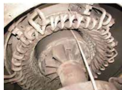
Рис. 1. Общий вид статора и ротора синхронного электродвигателя мощностью 10000 кВт.
