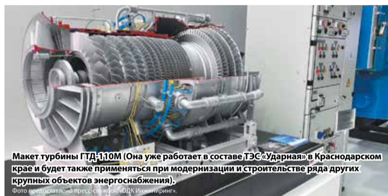
Первая отечественная турбина большой мощности ГТД-110М в составе ТЭС «Ударная» Фото: Объединенная двигателестроительная корпорация
